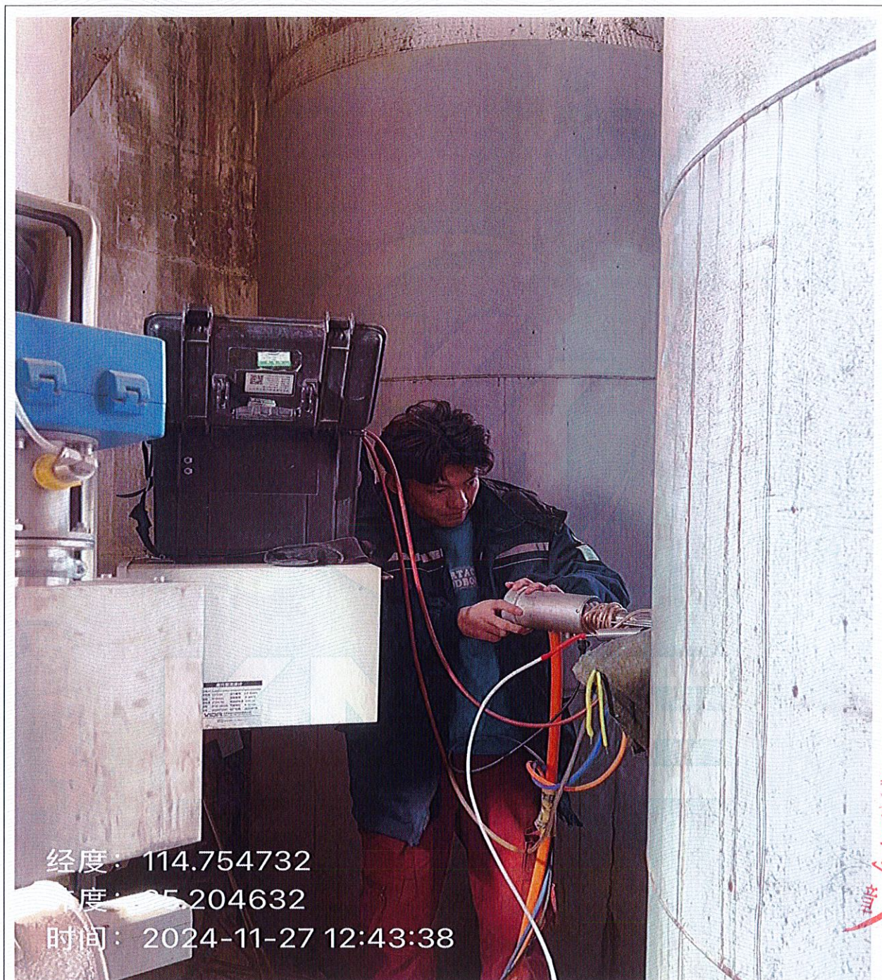
图 2-1 有组织检测 2#焚烧废气排放口 DA002
